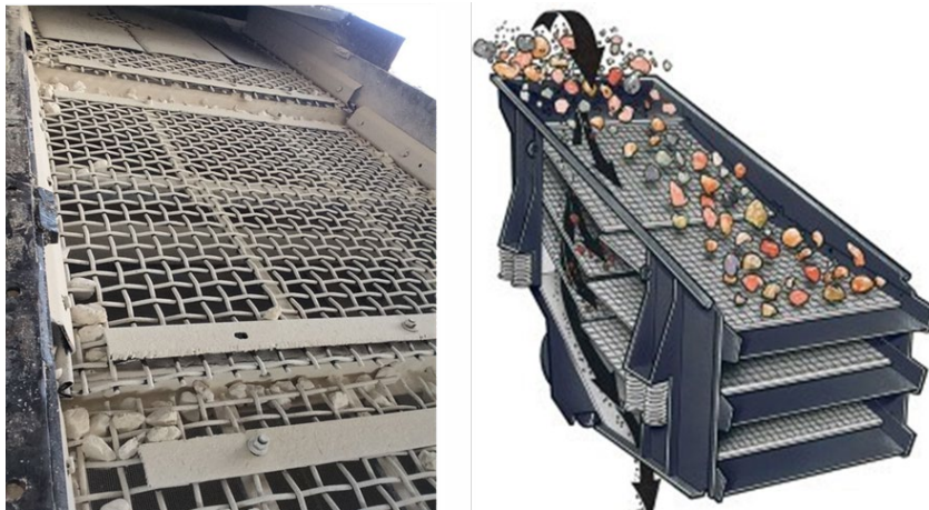
Şekil 5. Yanmış kireç taşı elemeye kullanılan çelik esaslı elek paneli gösterimi
