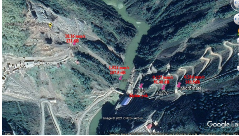
Şekil 8. Sismograflardan ölçülen titreşim ve hava şoku değerlerinin Google Earth üzerinde gösterimi
