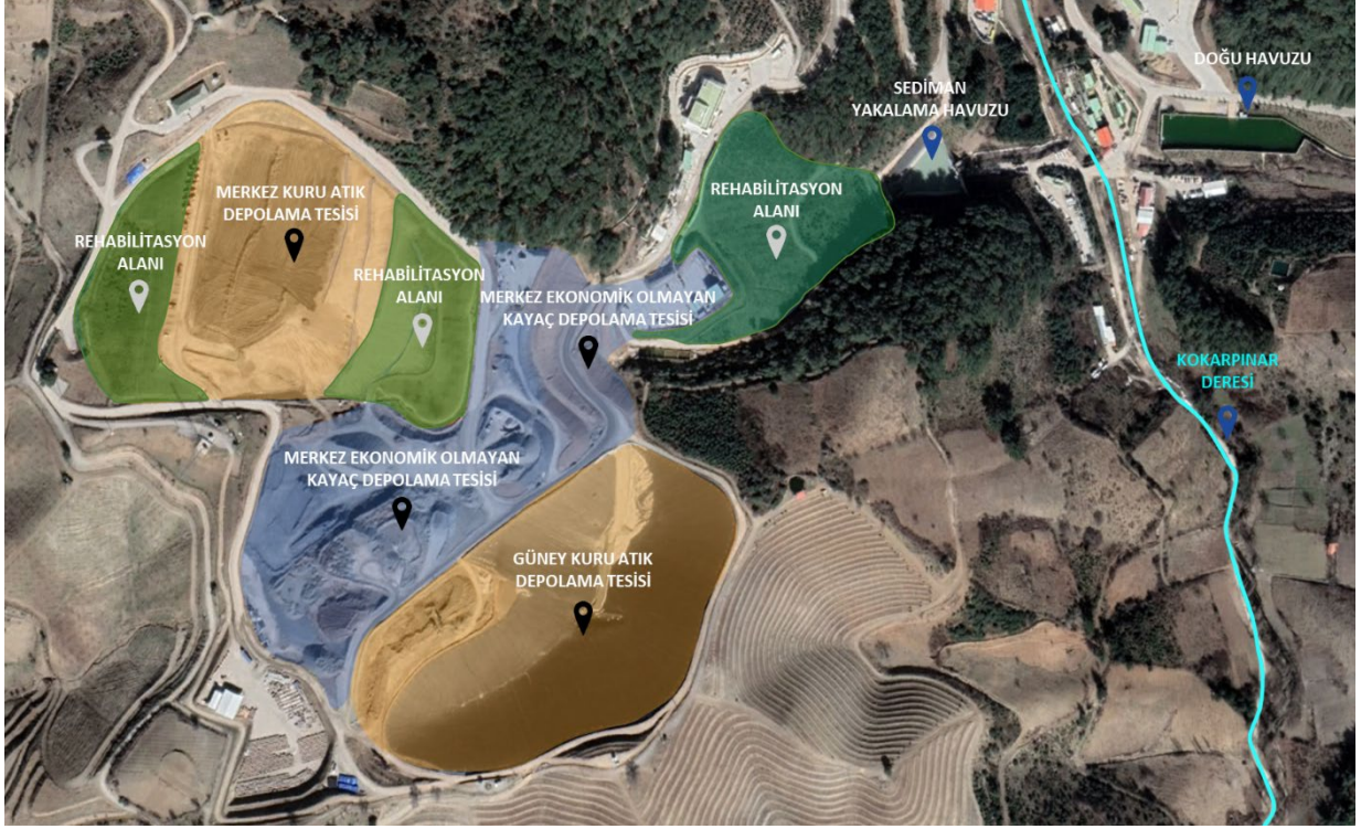
Şekil 1. Efemçukuru Altın Madeni Yerüstü Maden Atıkları Depolama Tesisleri Yerleşimi (Kasım 2020)
