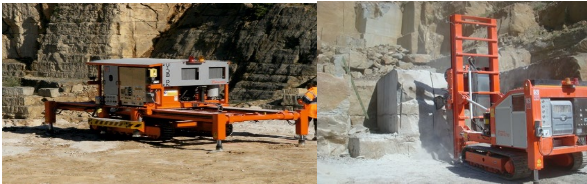
Şekil 7. Paletli sabit raylı ve kule tipli paletli kollu zincirli kesici makinaları
