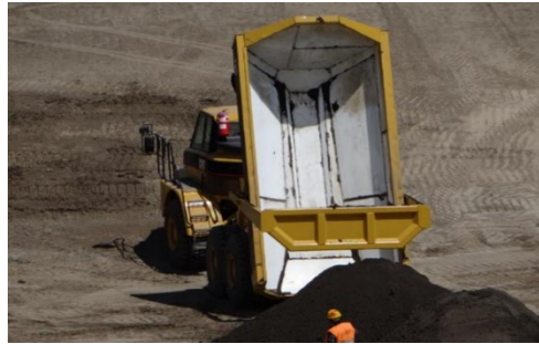
Şekil 36. Polimer ile kaplanmış kamyon damperi
