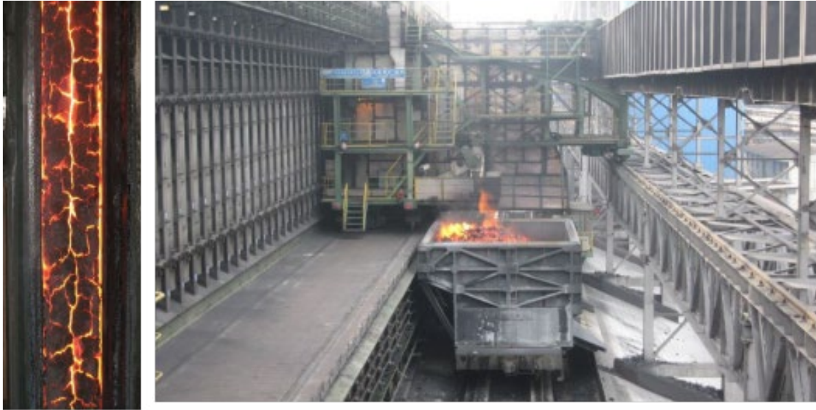
Şekil 2. Kızgın kokun söndürme vagonuna aktarılması
