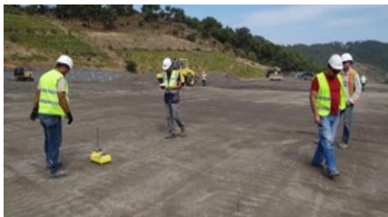
Şekil 10. Nükleer proktor cihazının kuru atık depolama alanında kullanılması
