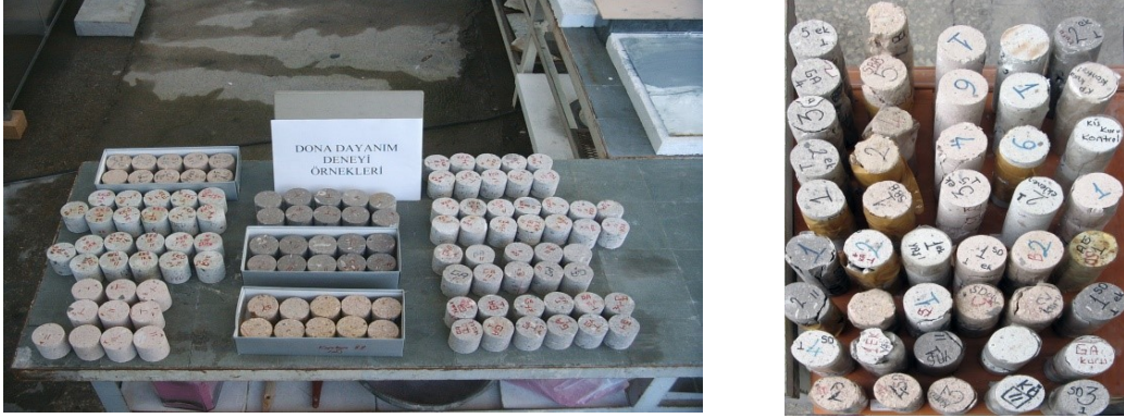
Şekil 6. Tek eksenli basınç dayanımı için kullanılan örnekler.
