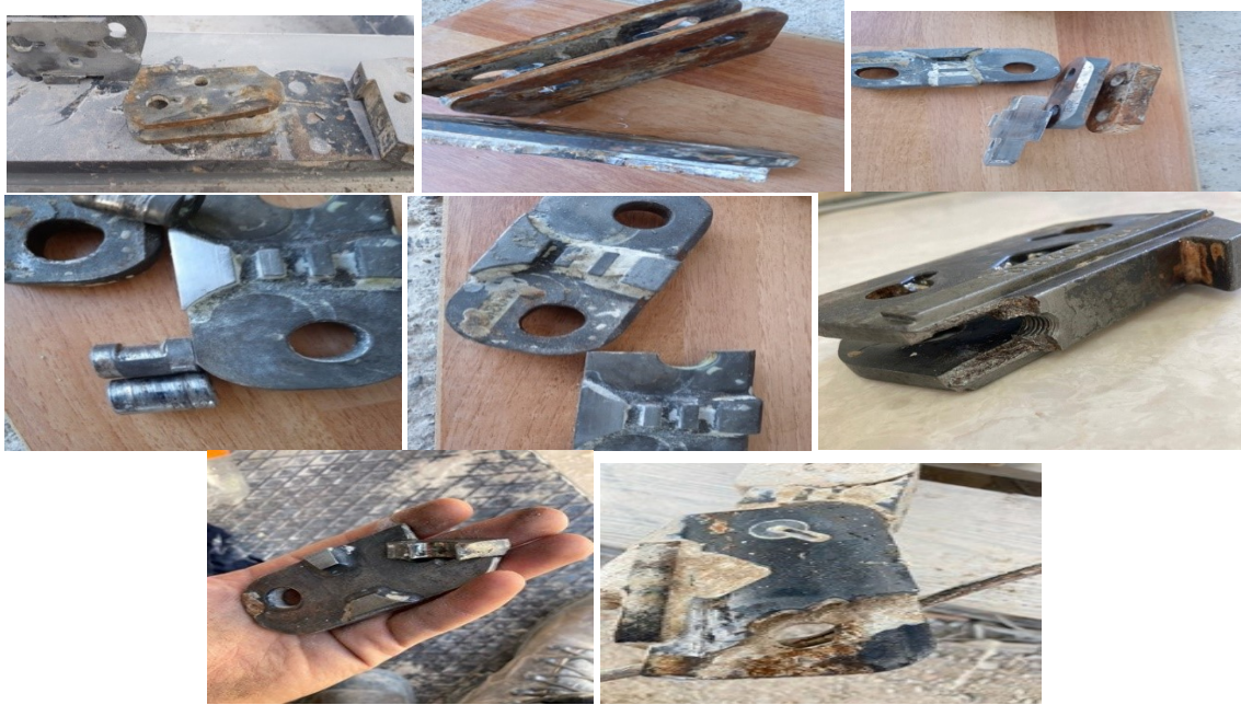
Şekil 9. Değişik marka makina ve ocaklarda iç-dış halka aşınma ve kırılma örnek resimleri
