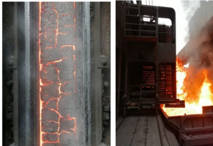
Şekil 3. Koklaşma prosesi ve plastik bölgenin oluşumu
