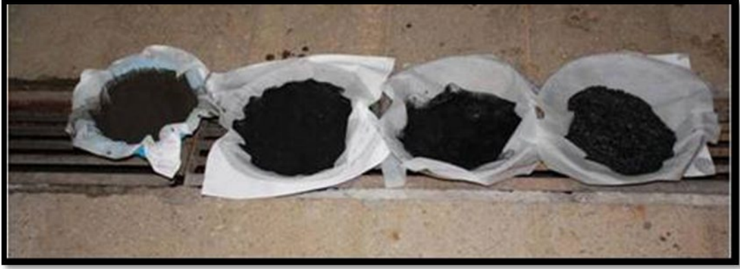
Şekil 3. Liç ve flotasyon işlemi sonrasında ürünlerin filtrasyonun görüntüsü
