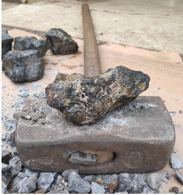
Şekil 2. Ön boyutlandırma işlemine tâbi tutulan bakır cevheri numuneleri
