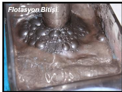
Şekil 4. Ayçiçek ve okaliptüs yağı ile flotasyonun başlangıcı ve bitiş anı görüntüleri
