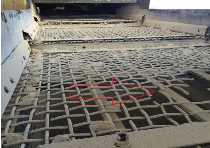
Şekil 6. Yanmış kireç taşı eleme esnasında çelik esaslı elek paneli üzerinde oluşan kopmaların gösterimi
