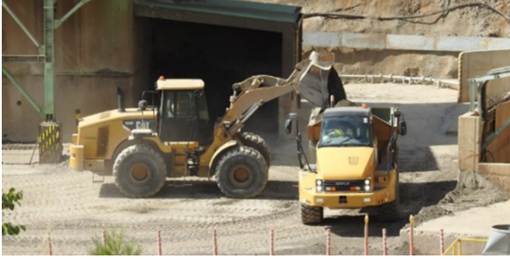
Şekil 2. Filtrelenmiş atığın kamyonu yüklenmesi
