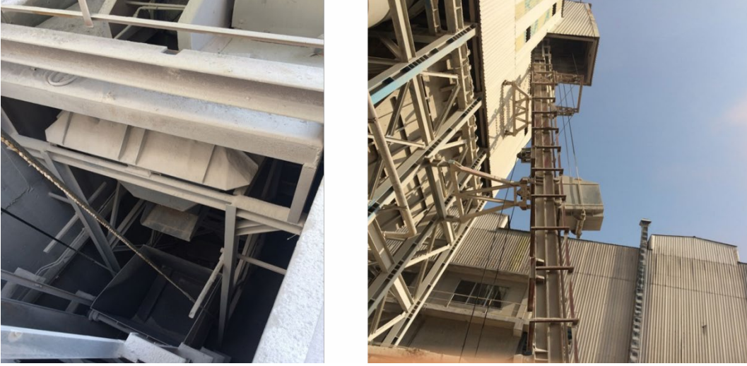
Şekil 4. Kireç taşı dolu skip arabasının eğik ray yolu üzerinde silo üstü bunkerine doğru hareketinin genel görünümü
