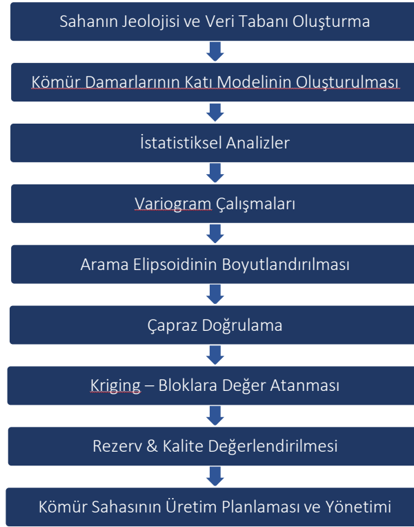
Şekil 2. İlgın kömür sahası kaynak modelinin tayininde uygulanan yöntemin akış şeması
