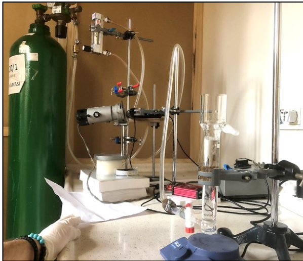
Şekil 6. Mikro-flotasyon deney düzeneği ve örnek bir deney
