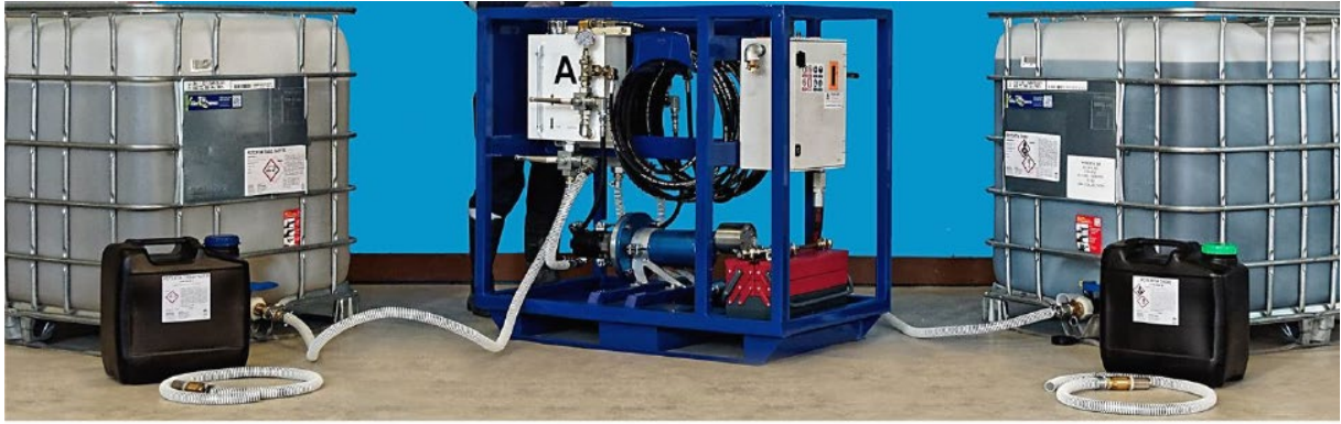
Şekil 3. Pompalanabilir kaya saplama reçinesi için kullanılan enjeksiyon sistemleri örneği (Weber Madencilik, 2020).
