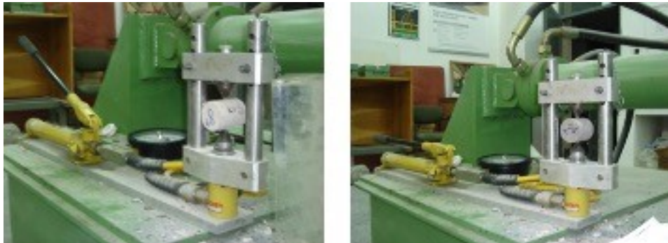
Şekil 1. Nokta yükleme deney düzeneği
