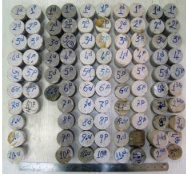
Şekil 5. Nokta yükleme deneyinde kullanılan örnekler.
