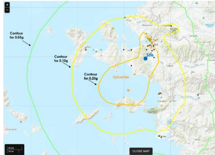
Şekil 4. Deprem konumu ve 1 saniyedeki Spektral İvmenin konturları. Veriler USGS web sitesinden uyarlanmıştır.
