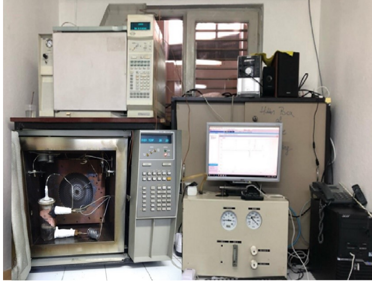
Şekil 12. Numunenin kendiliğinden yanma fırınına ve reaktöre yerleştirilmesi ve gerekli hava bağlantılarının tamamlanmasına ait görsel.
